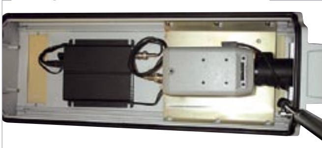
Analog-Kamera und Video-Server in einem Gehäuse
